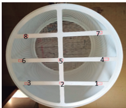
Figura 1. Câmara experimental, os pontos no teto em que era possível posicionar a barra que era ligada a argola.
